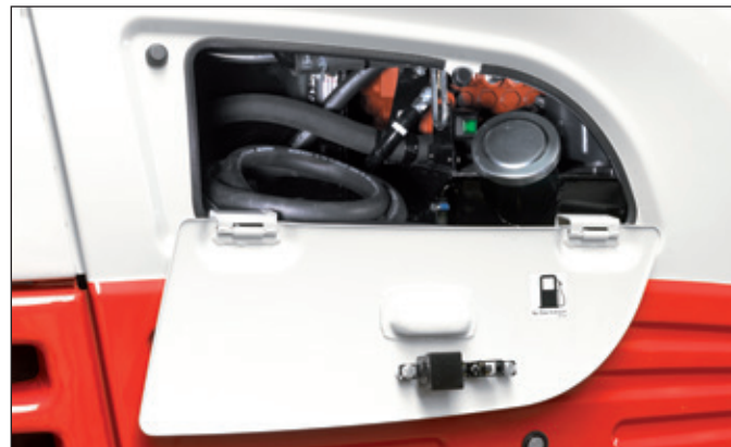
Zusätzliche Öffnungsklappe für optimalen Zugang zu Betankungspumpe und Tankdeckel.
