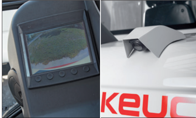
Übersichtliches Multifunktionsdisplay mit Einblendung der Rückfahrkamera. ECO-Modus zur Erhöhung der Wirtschaftlichkeit und Verringerung des Dieserverbrauchs.
