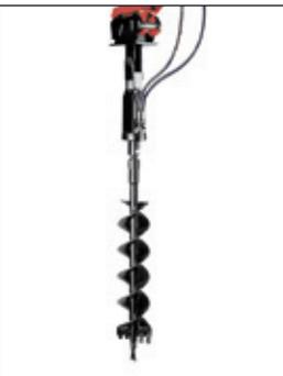
Erbohrer mit Bohrschnecke
