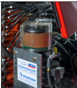
Mengengesteuerte Zentralschmieranlage mit Leerstandsmeldung
