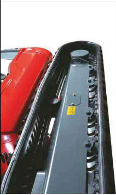
Laufrollen mit Innen- und Außenführung für sicheren Gummikettenlauf und Double-Short-Pitch Gummiketten für vibrationsarmes Fahren.
