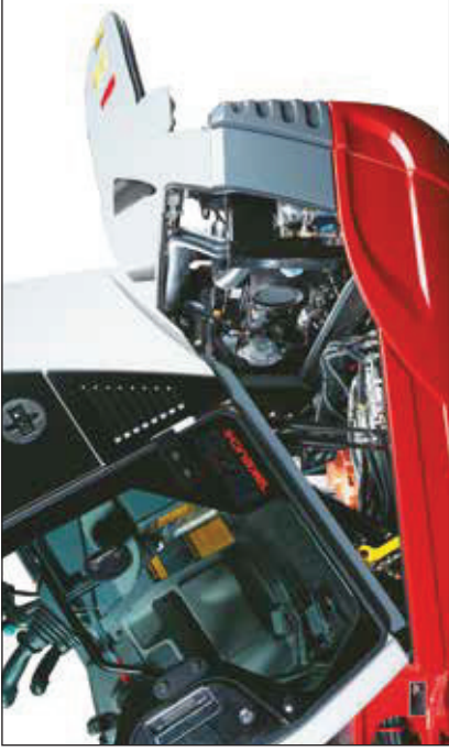
Kippbare Kabine mit servicefreundlichem Zugang zum Motor und den Hydraulikaggregaten.
