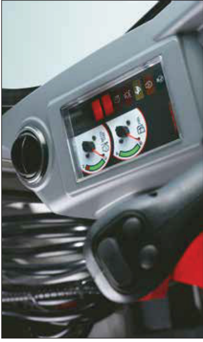
Armaturenbrett mit hör- und lesbaren Warnungen im Falle einer Störung während des Betriebes.
