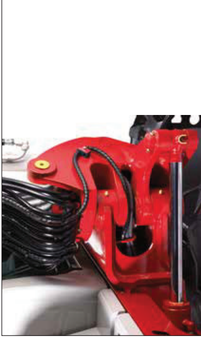
Robuster Schwenkbock mit besonders geschützter Schlauchführung und hydraulischer Seitenversetzung mit Büchsen in allen Positionen.
