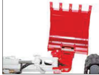
Powerlöffel mit hydr. Schnellwechsellatte, Tieflöfel als Hochlöfel montiert
