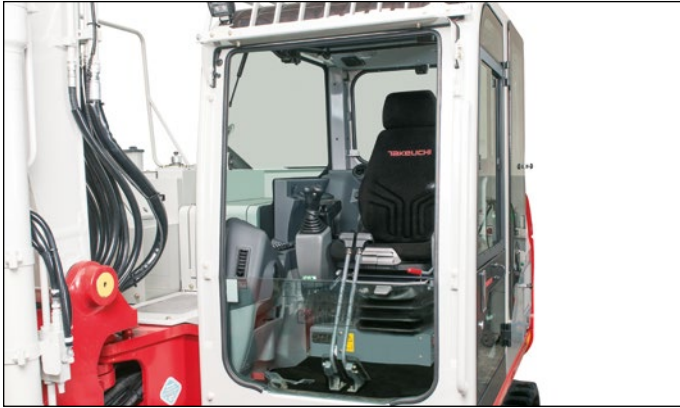
Schallgedämpfte, vibrationsarme Komfortkabine mit Ablagefächern.
