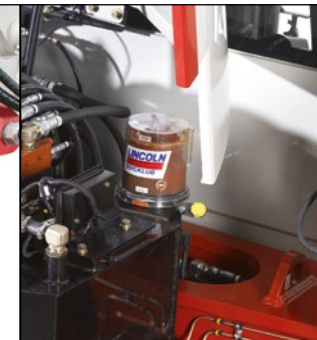
Mengengesteuerte Zentralschmieranlage mit Leerstandsmeldung
