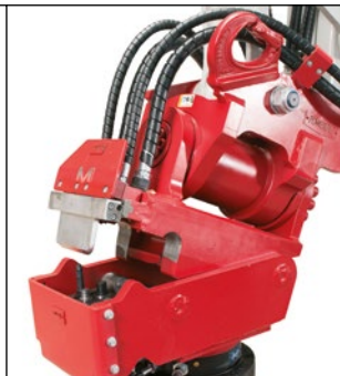
System Huppi-Quick: Hydraulikanlüsse werden beim Schnellwechselfvorgang automatisch verbunden
