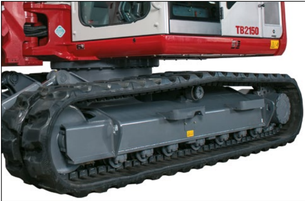
Doppelte Laufrollenführung und extrastarkes Leitrad.
